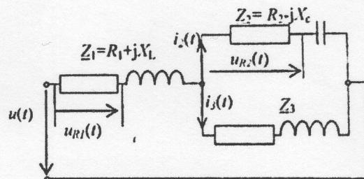
4. V vezju na sliki smo izmerili toke  $I_1 = 6 \text{ A}$ ,  $I_2 = 4 \text{ A}$  in  $I_3 = 3 \text{ A}$ . Izračunajte elemente vezja ( $R$ ,  $L$  in  $C$ ), če poznamo  $X_{L2} = 10 \Omega$  (vezje deluje pri  $\omega = 500 \text{ s}^{-1}$ )
