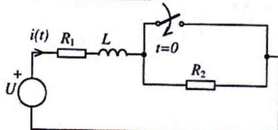
Izračunajte začetne in stacionarne vrednosti, izračunajte korene karakteristične enačbe in zapišite nastavek za prehodni pojav, če v trenutku  $t=0$  izklopimo stikalo.
