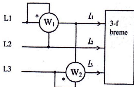
3. V uravnoteženem trifaznem sistemu so bremena vezana v trikot:  $Z_{12} = Z_{23} = Z_{31} = 10 + j10 \Omega$ . V sistemu pride do okvare (prekinitev na bremenu med sponkama 1 in 2). Izračunajte linijski tok  $I_2$  pred in po okvari, če je dana medfazna napetost (simetričnega napajanja)  $E_{12} = 200 \cdot e^{j30^\circ} \text{ V}$ .
